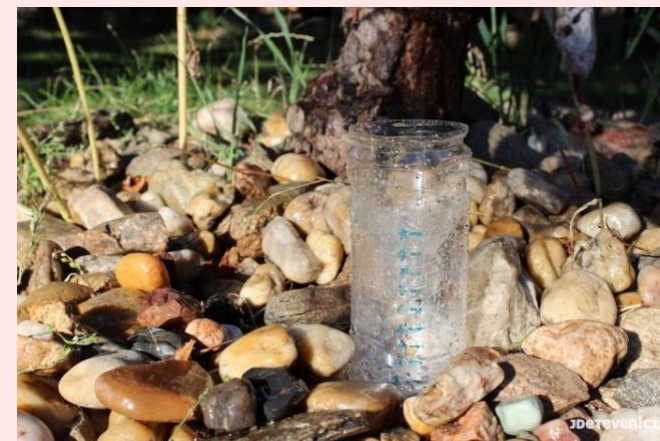
Obrázek 9 Srážkoměr (Jdeteven!.cz). Návod na vytvoření jednoduchého srážkoměru získáte kliknutím na obrázek.
